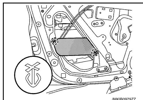
15. 拆下前车门调节器总成装配螺栓。
