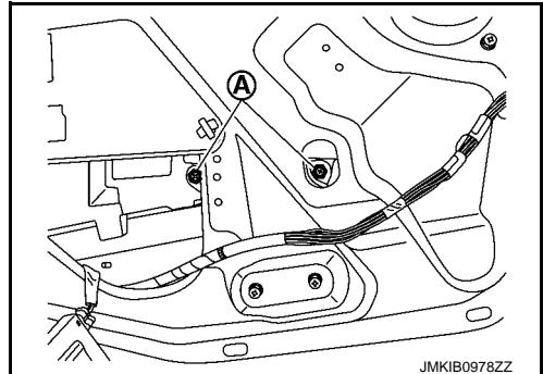
8. 拆卸玻璃装配螺栓。
