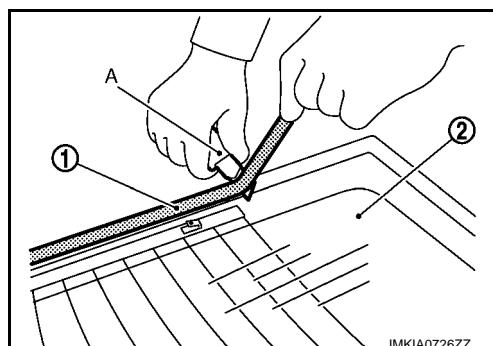
3. 在安装新玻璃时，将玻璃安装在车辆上并在车身及玻璃上做配合标记。然后再次拆下玻璃。
