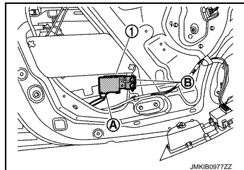
14. 拆下前车门内衬块固定卡子，然后拆下前车门内衬块。
