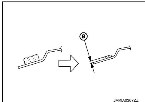
2. 当重复使用玻璃 ② 时，使用切割工具 (A) 清除残留的粘合剂 ① (密封胶)，并将表面修整平滑。
