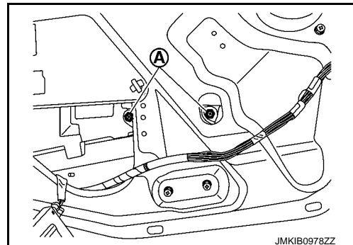
10. 拆下前车门玻璃装配螺栓。
