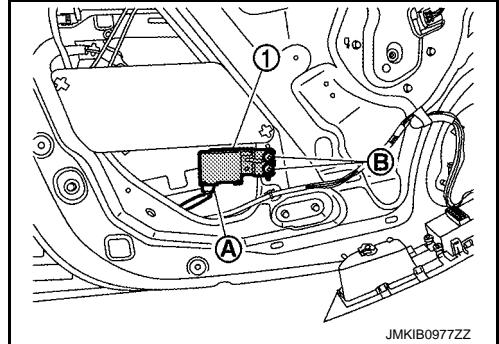
6. 连接电动车窗主开关部件。
